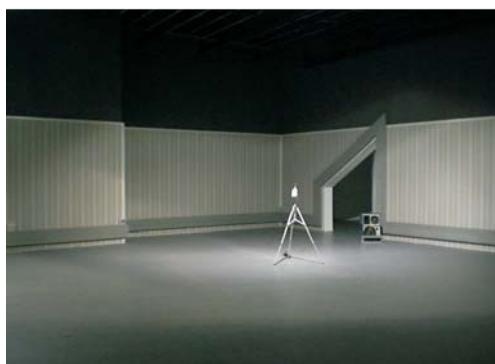
Medición de Tr y aislamiento acústico en plató de TV (Málaga).
